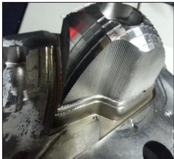
模仁加工 AICAM 10%无人化+手动编程
